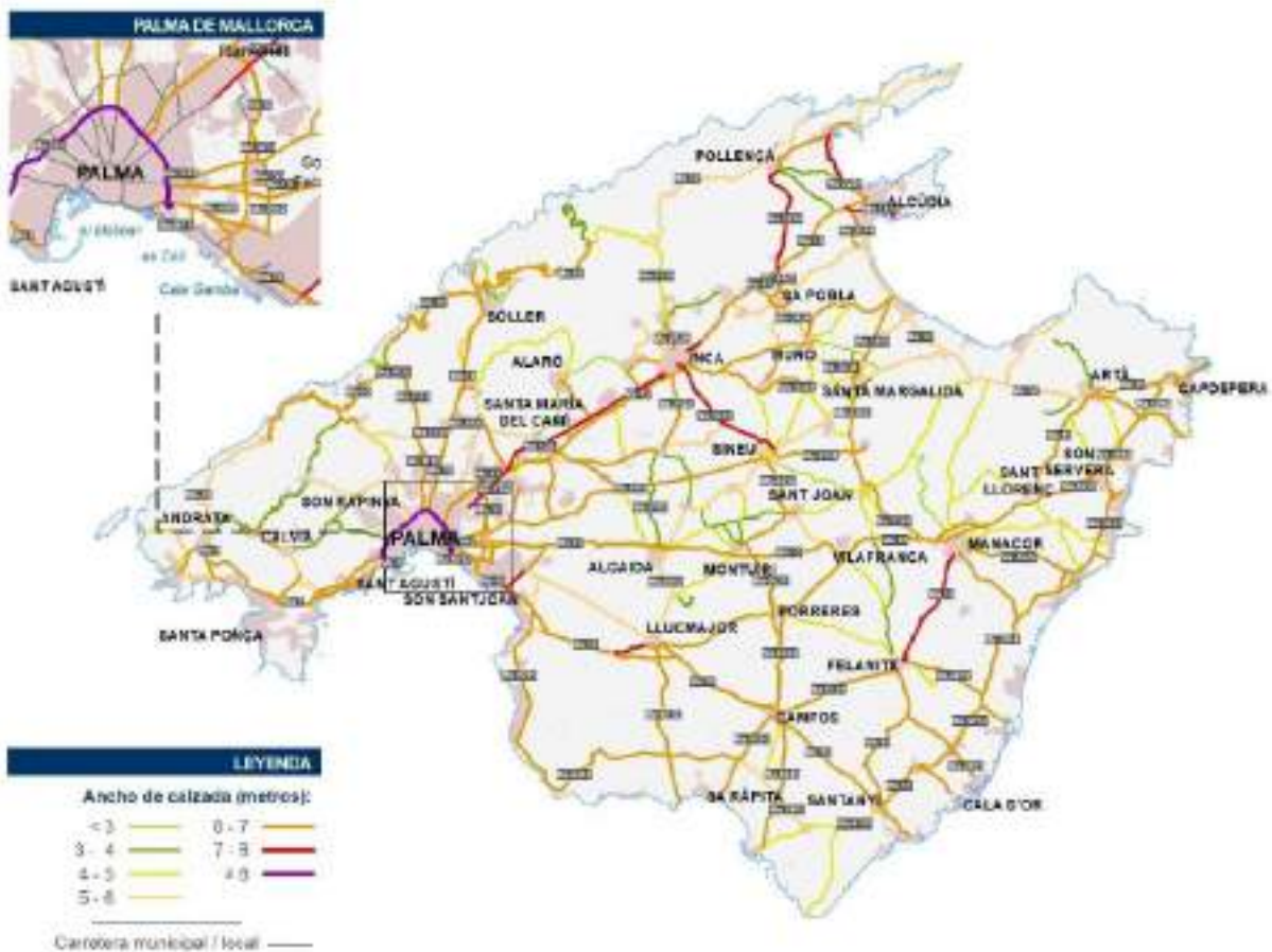
Fig. 60. Ancho de calzada de las carreteras de Mallorca
